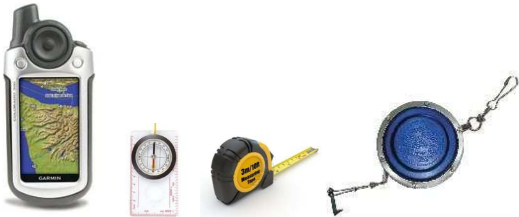
Figura 5. Esempi di strumentazione necessaria per il campionamento: da sinistra GPS, bussola, metro avvolgibile, rotella metrica con gancio
